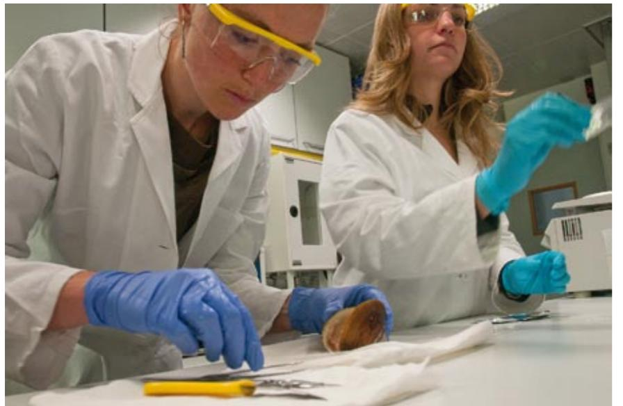
Der Steidle-Bau des AWI ist mit modernsten Laboren ausgestattet, in denen fachübergreifende Grundlagenforschung betrieben wird. So lassen sich beispielsweise im Gewebe und der Schale von Muscheln (l.) Klimaveränderungen erkennen. Das Gewebe wird unter Kühlung homogenisiert (u. l.) und auf seine chemischen Bestandteile untersucht (r.).
