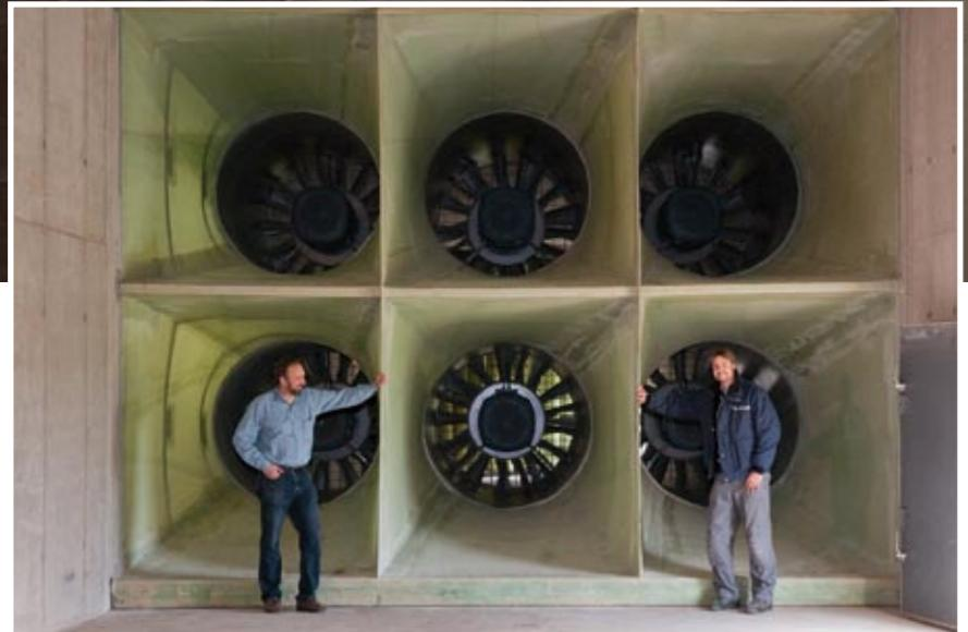
Viele Unternehmen aus der Windenergiebranche arbeiten in Bremerhaven. Bei der *WindGuard* wird der Wind gleich selbst gemacht: Gerd Gerdes und Nicholas Balaresque zeigen die Rotoren, die im umlaufenden Kanal Windgeschwindigkeiten bis zu 270 km/h erzeugen; dort werden u. a. Bauteile aerodynamisch und akustisch optimiert.
